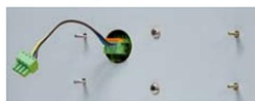
打好孔后，先安装操作面板。从背面撕下垫圈上的纸，将键盘接线从孔中穿过。在背面安装 2 个螺丝钉将操作面板固定。
